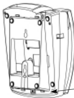
Figure 14 - Cale de blocage installée pour montage mural.
